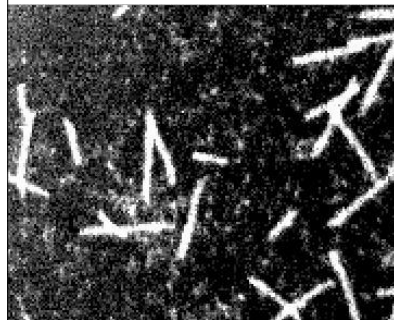
Снимок p-T треков в газе \text{He3/CF4} сделан CCD-камерой
