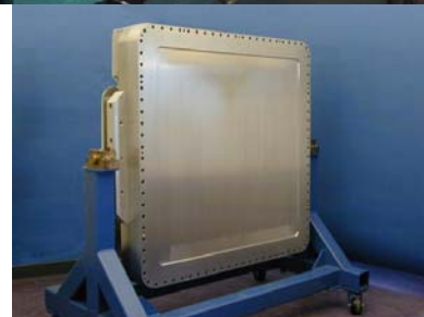
Детектор 21000N ORDELA с входным окном 1 \text{ м} \times 1 \text{ м} , временное разрешение 3 мкс, интегральная нагрузка 200 кГц, пространственное разрешение 5.1 \times 5.1 \text{ м}^2 , эффективность 50%–80% (2-5 Å)
